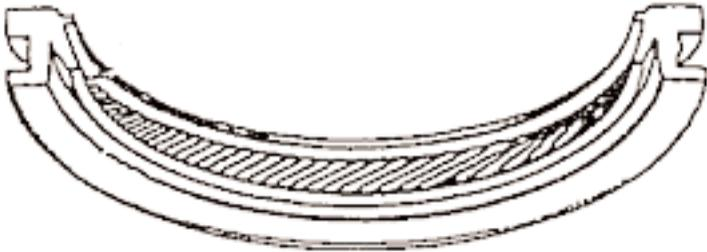
Lagerschalen und Kurbelwellenzapfen mit sauberem Motoröl einölen und Kurbelwelle vorsichtig einsetzen.
